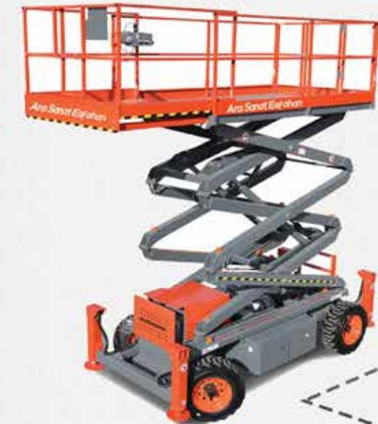
تمامی بالابرها آکاردئونی نفر بر . مجهز به سیستم هیدرولیک و سامانه ی اینمنی ذیل هستند :
